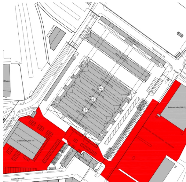
Konzeptvorschlag mit Sattelzug zu befahrende Fläche (rot)
